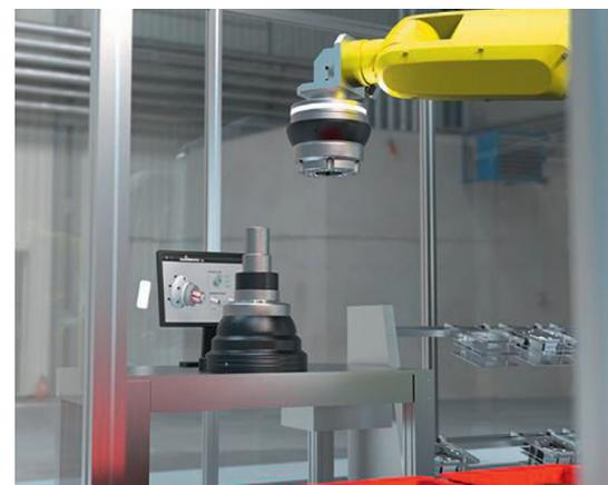
2 Bei der Verwendung als Messstation wird der IQ-Spanndorn zur Messung der gefertigten Werkstückbohrung eingesetzt © Hainbuch
